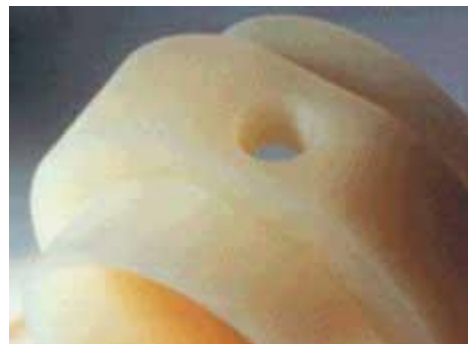
Рис. 3. Детали, сделанные из PVDF, обладают высокой устойчивостью к воздействию кислот, алифатических и ароматических углеводородов, спиртов и галогенизированных растворителей.
